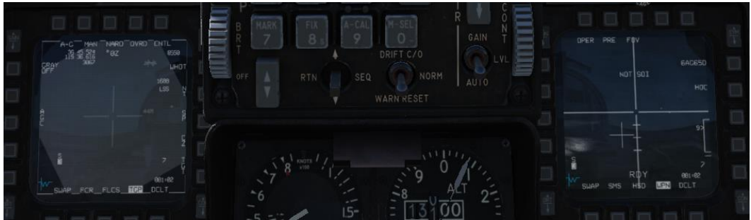
TGP 和 AGM-65 都是在无增量情况下开始，直接指向当前转向点。
