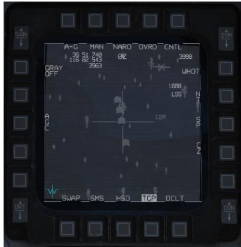
瞄准吊舱处在 INR（惯性速率）跟踪模式下（十字扩大）
