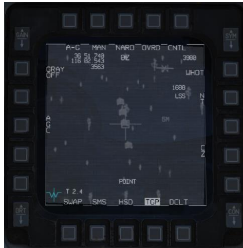
瞄准吊舱处在 POINT 跟踪模式（方框包围跟踪目标）
