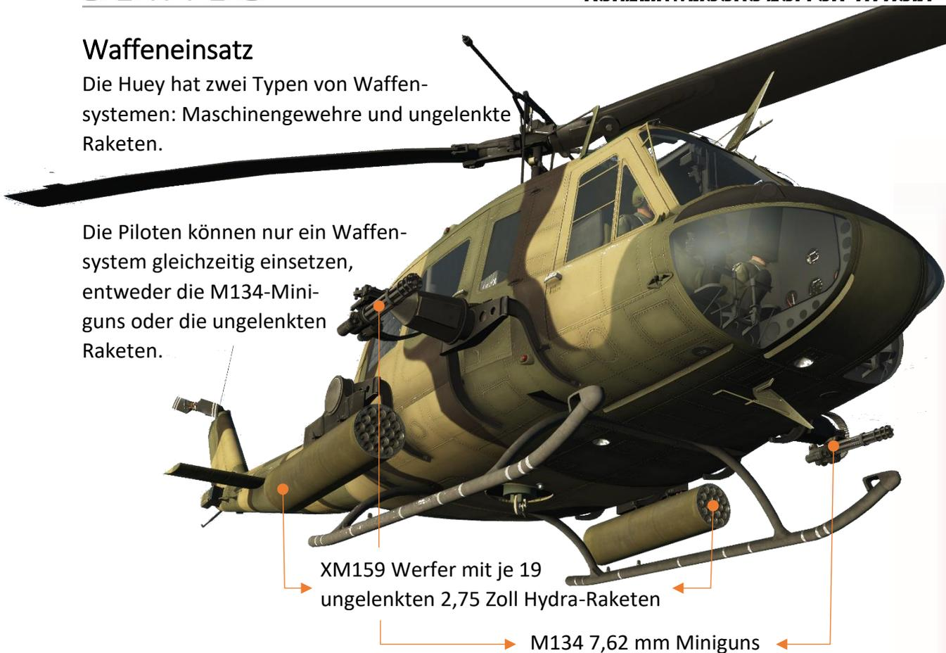
Die schwenkbaren Miniguns werden üblicherweise vom linken Sitz (Copilot) bedient, können aber auch mit dem Visier des Piloten starr gefeuert werden.
