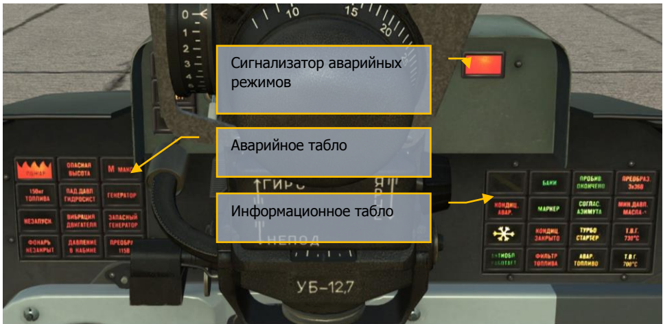
Рис. 108. Аварийное, информационное табло и сигнализатор аварийных режимов передней кабины
