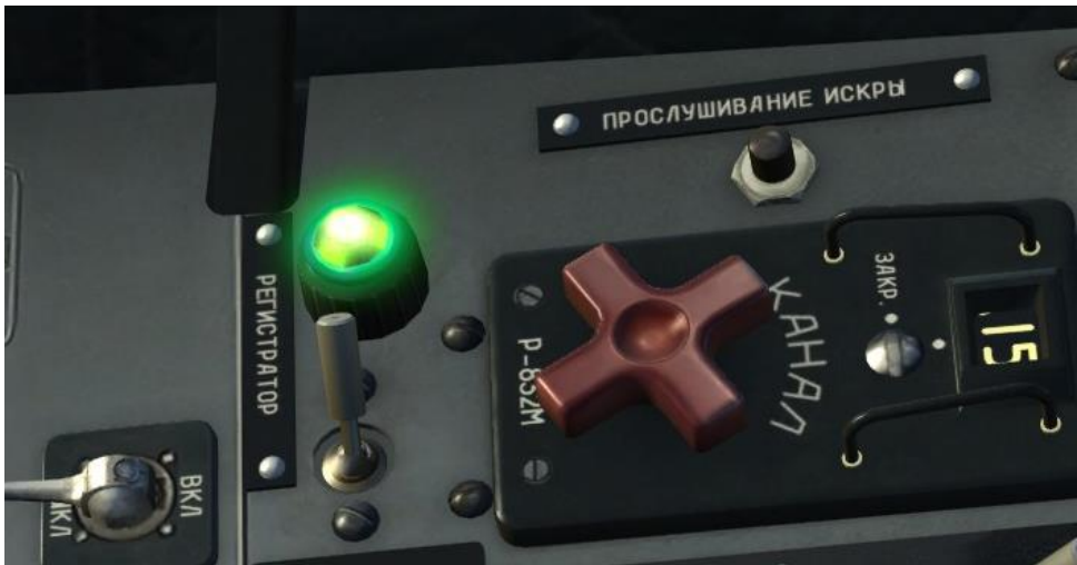
Рис. 134. Выключатель РЕГИСТРАТОР и сигнальная лампа
