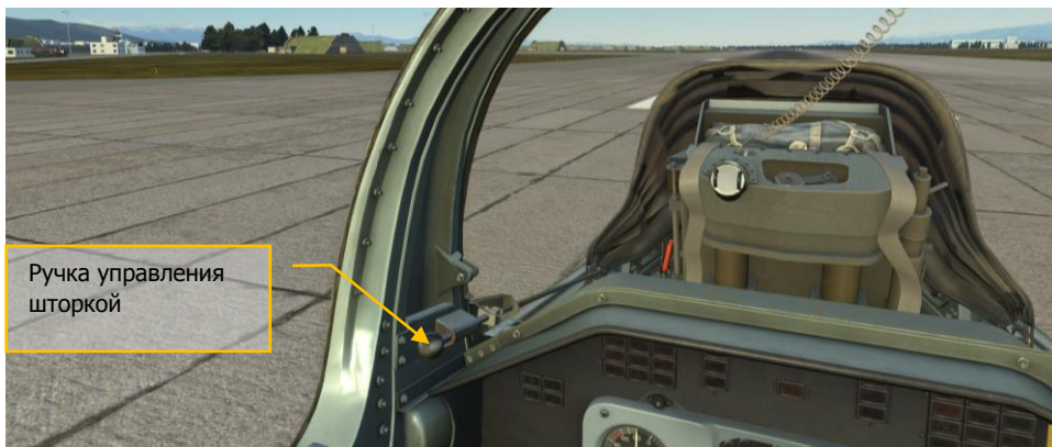
Рис. 51. Вид на закрытую шторку из задней кабины и ручка управления шторкой
