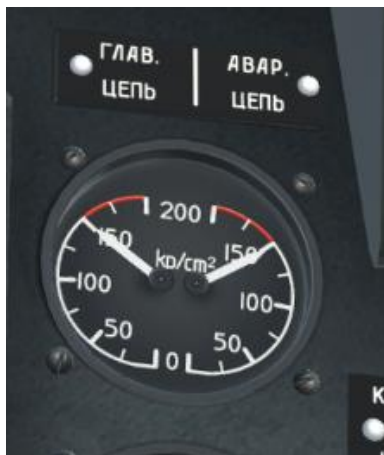
Рис. 54. Двухстрелочный манометр основной и аварийной гидросистемы
