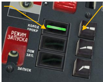
Рис. 59. Сигнализатор положения и кнопки управления закрылками
