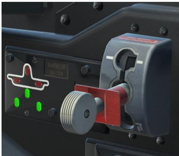
Рис. 56. Переключатель управления шасси в задней кабине
