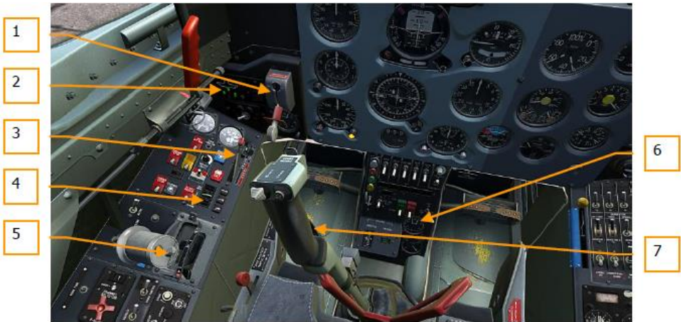
Рис. 61. Органы управления и индикации основной гидросистемы в передней кабине
