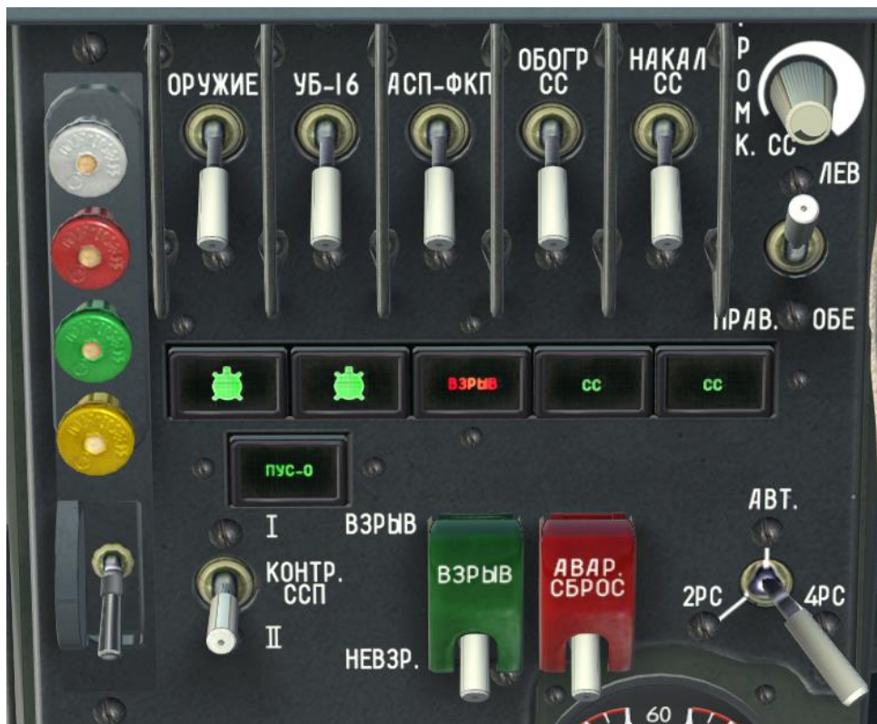
Рис. 167. Пульт управления вооружением в передней кабине
