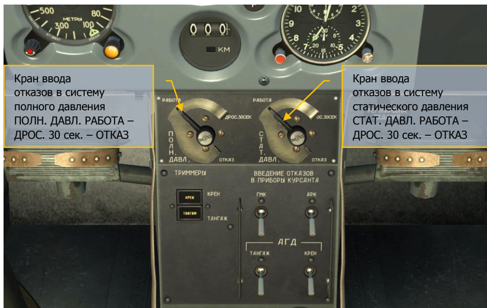
Рис. 113. Пульт ввода отказов в приборы передней кабины
