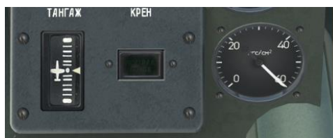
Рис. 67. Манометр аварийной системы торможения в передней кабине
