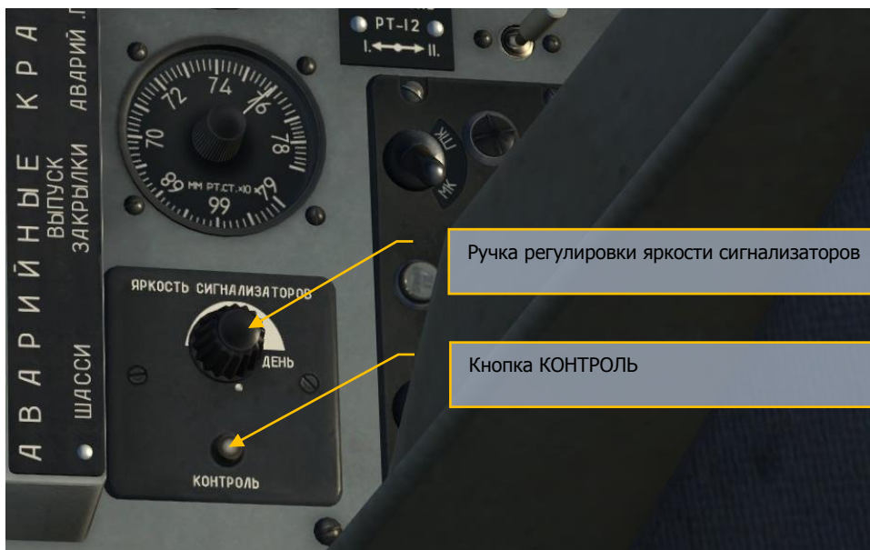
Рис. 110. Панель контроля исправности сигнальных ламп всех табло
