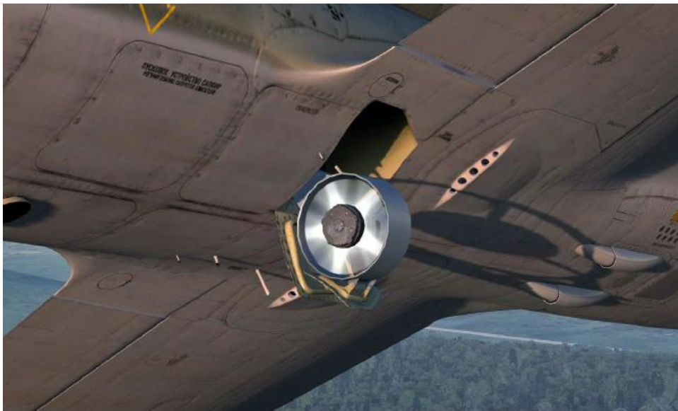
Рис. 95. Запасной генератор ГСР-3000 в выпущенном положении
