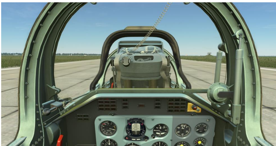
Рис. 148. Положение линии горизонта в передней (сверху) и задней (внизу) кабине при разбеге на двух колёсах
