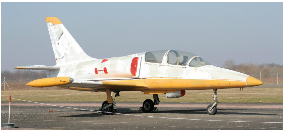
Рис. 11. L-39V (Vlečná — буксировщик) — одноместный буксировщик мишеней КТ-04
