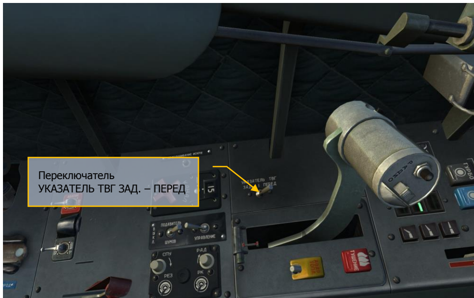
Рис. 94. Переключатель УКАЗАТЕЛЬ ТВГ ЗАД. – ПЕРЕД
