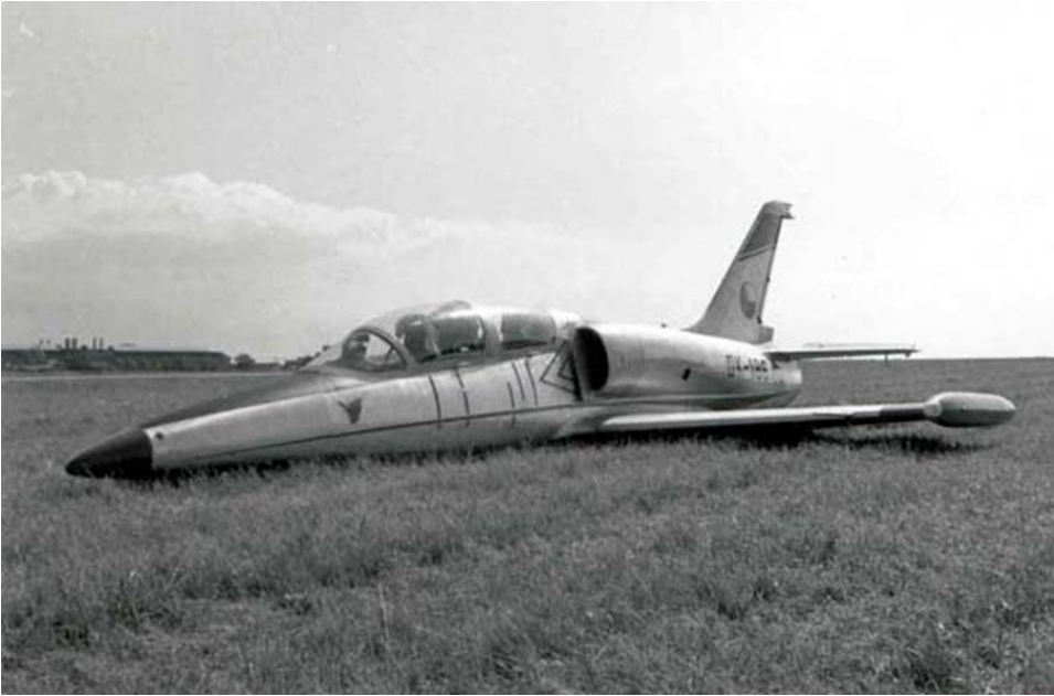
Рис. 9. Прототип X-06 после аварийной посадки «на брюхо»
