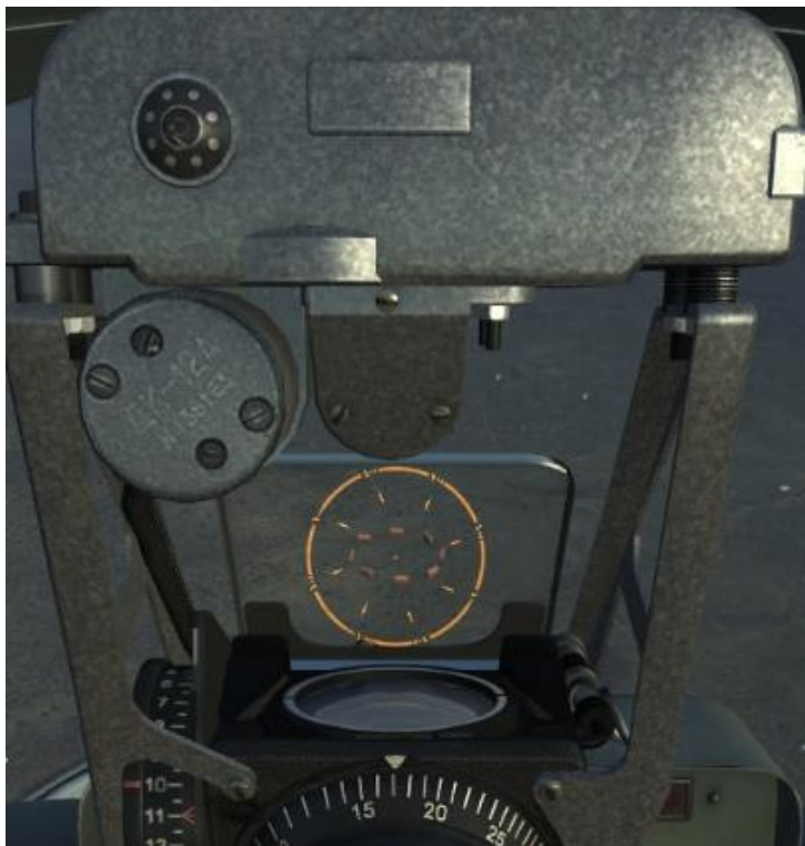
Рис. 177. Положение центральной точки сетки прицела относительно цели в момент нажатия на боевую кнопку
