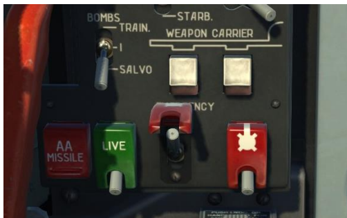
Рис. 208. Переключатель АВАРИЙНО (EMERGENCY) в передней кабине
