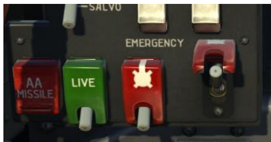
Рис. 195. Переключатель АВАРИЙНО (EMERGENCY) в передней кабине
