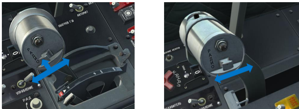
Рис. 60. Переключатель управления тормозными щитками в передней (слева) и задней (справа) кабине
