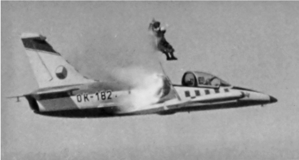
Рис. 7. Испытание катапультного кресла ВС-1БРИ
