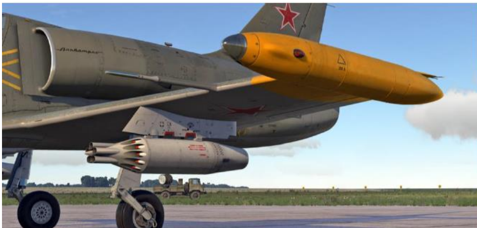
Рис. 48. Пилон, ПВД, аэронавигационный огонь, посадочно-рулѐжная фара и концевой топливный бак
