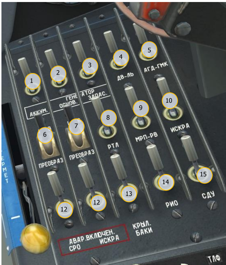
Рис. 96. Основной электрощиток в передней кабине
