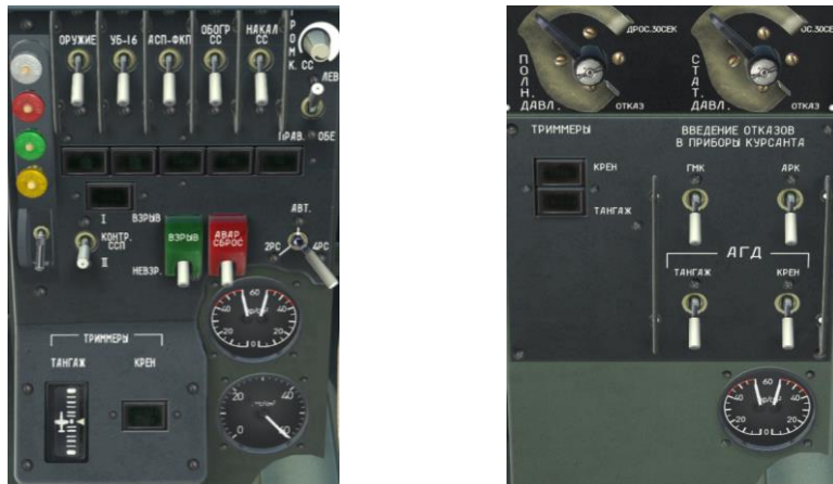
Рис. 57. Двухстрелочный манометр в передней (слева) и задней (справа) кабине
