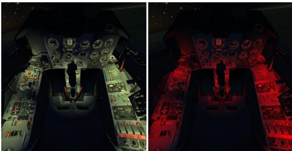
Рис. 102. Белое и красное освещение передней кабины
