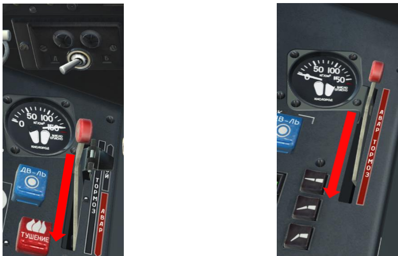
Рис. 66. Кран аварийного торможения в передней (слева) и задней (справа) кабинах
