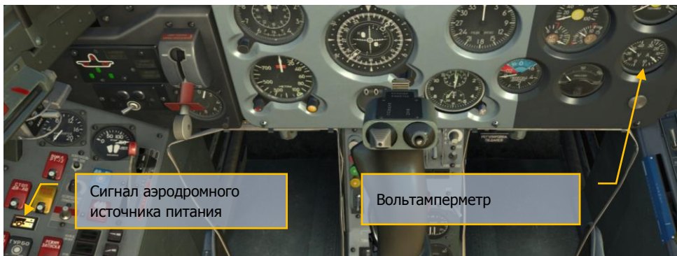
Рис. 99. Сигнал аэродромного источника питания и вольтамперметр
