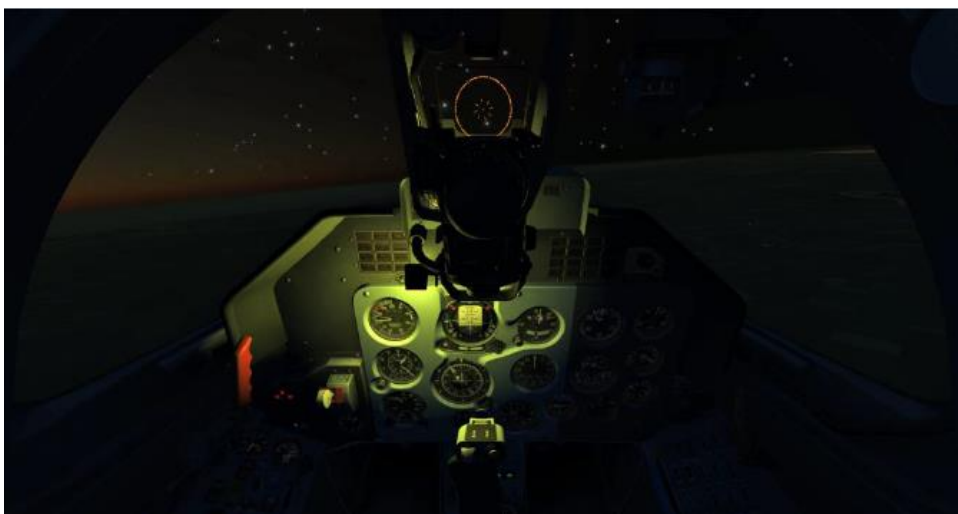
Рис. 103. Аварийное освещение в передней кабине
