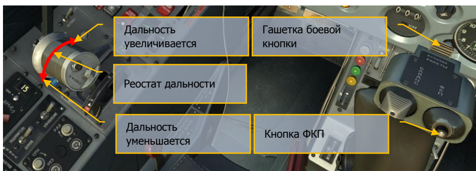
Рис. 173. Органы управления вооружением в передней кабине
