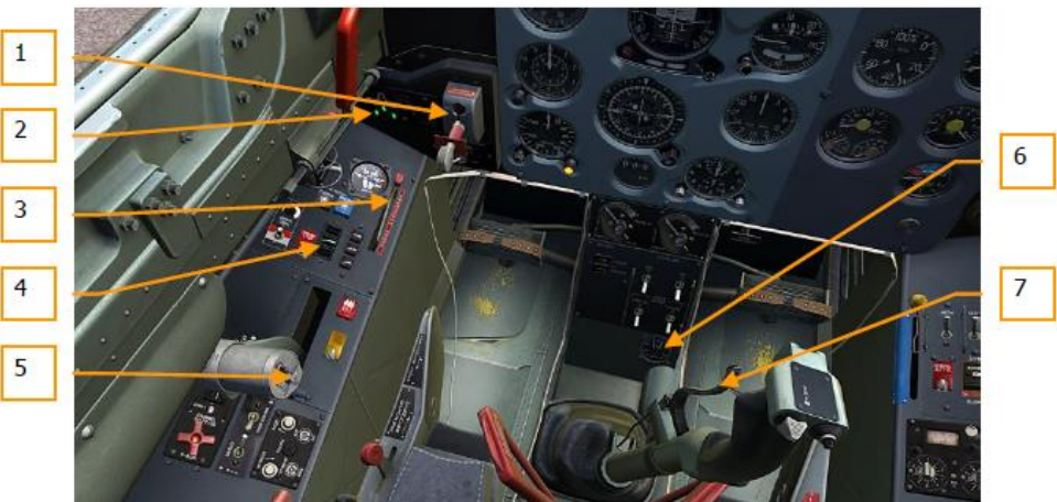
Рис. 62. Органы управления и индикации основной гидросистемы в задней кабине
