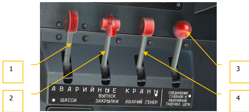
Рис. 64. Краны аварийной гидросистемы и кран соединения основной и аварийной гидросистемы
