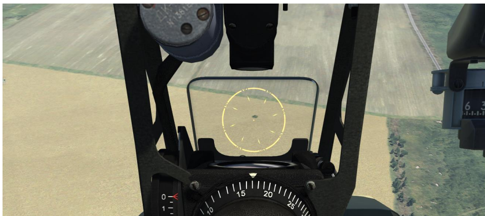
Рис. 178. Положение центральной точки сетки прицела относительно цели в начале пикирования
